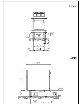
Electrical inlet (power) EQ Equipotential screw
